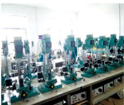
超声波研磨机 Ultrasonic grinding machine
