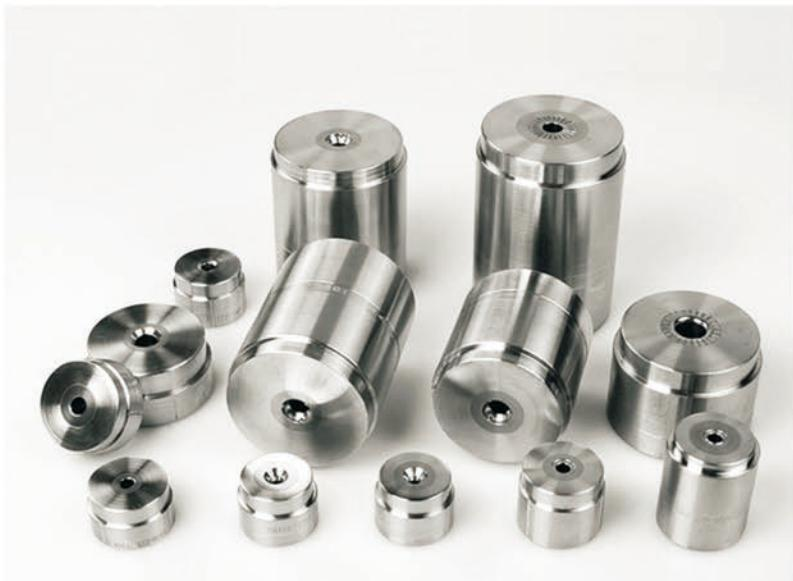
螺丝模具主要包括主模、预冲模、头冲模、成型模具、切料模具、切刀、螺母模具、六瓣组合模具、多工位模具、六角冲光模具、六角切边模、模壳、顶针等；选用台湾春保、株洲钻石、自贡长城耐冲击硬质合金材料制作，具有高抗击韧性及抗疲劳强度、不易崩缺，不易断裂，耐磨性强、不易磨损，精密度高、稳定性强、使用寿命长等特点。
