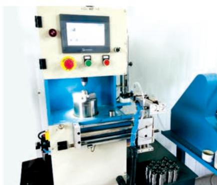
全自动定径研磨机 Automatic sizing mill
