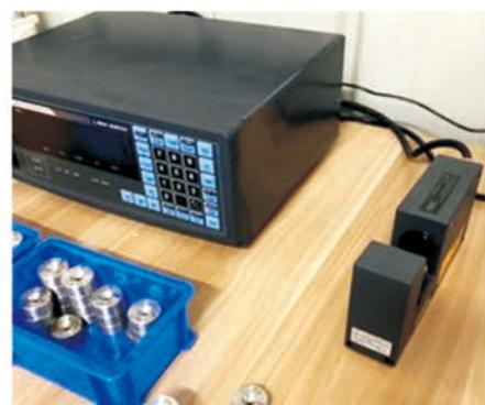
非接触激光外径测试仪
